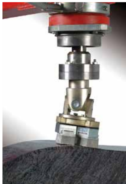
Bogenshleifen mit Kardangelenk Curve grinding with cardan joint
