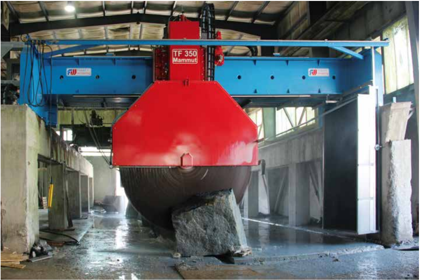
Blocksäge mit starrer Schutzhaube Block Saw with rigid protection hood
