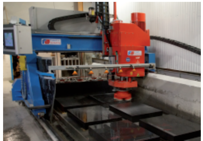
ASP 206c - Halbportal mit Höhenverstellung ASP 206c - Half gantry with height adjustment
