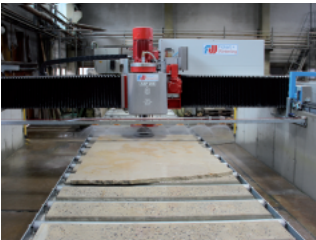
Weichgestein schleifen und stocken Grinding and bushhammering of softstone
