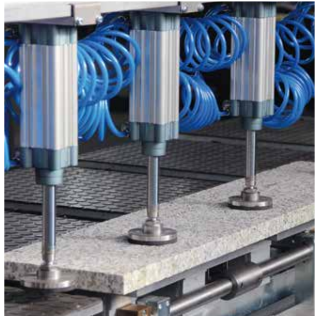
Pneumatische Werkstückspannung Pneumatical workpiece clamping
