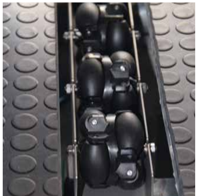
Anhebbare Allseitenrollen Liftable polydirectional rolls
