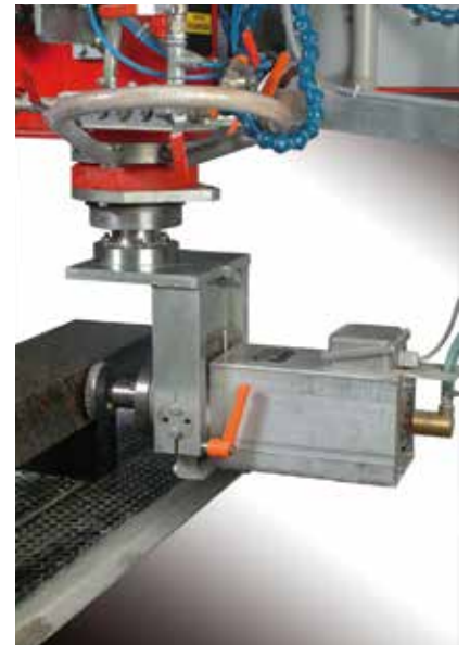
Kantenbearbeitung mit Seitenschleifaggregat Edge processing with side-grinding unit
