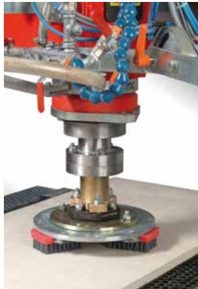
Flächenschleifen von Weichgestein Surface polishing of soft stone
