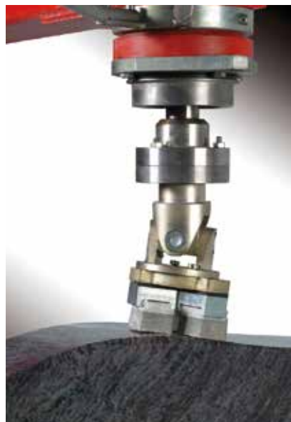
Bogenshleifen mit Kardangelenk Curve grinding with cardan joint
