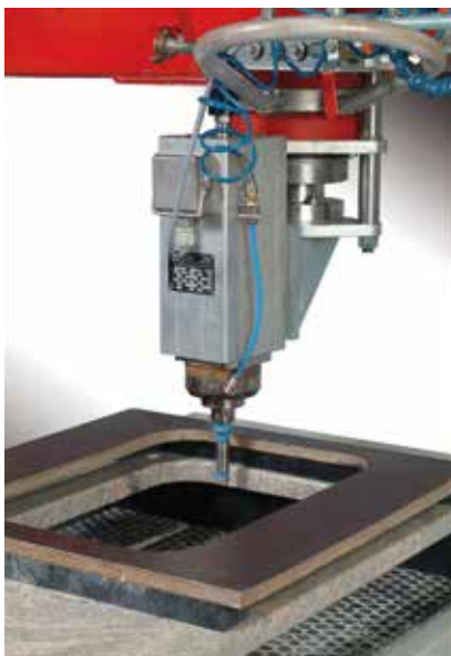
Schnelllaufspindel für Fingerfräserwerkzeuge High-speed spindle for end-milling tools
